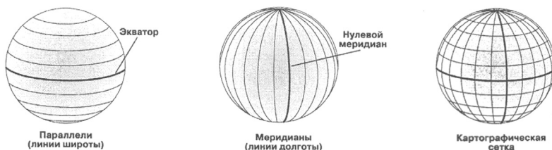
Рис. 5. Параллели и меридианы, которые образуют картографическую сетку
