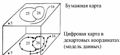
Рис. 11. Простейшая векторная структура данных – «спагетти-модель»
