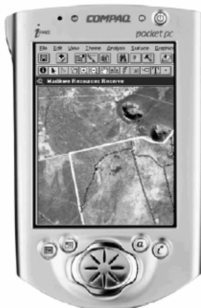
Рис.1.11. Карманный ПК Compaq, применяемый для сбора и анализа ГИС данных.
