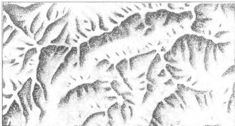
Рис. 5.8. Отмывка рельефа при северо-западном освещении.
