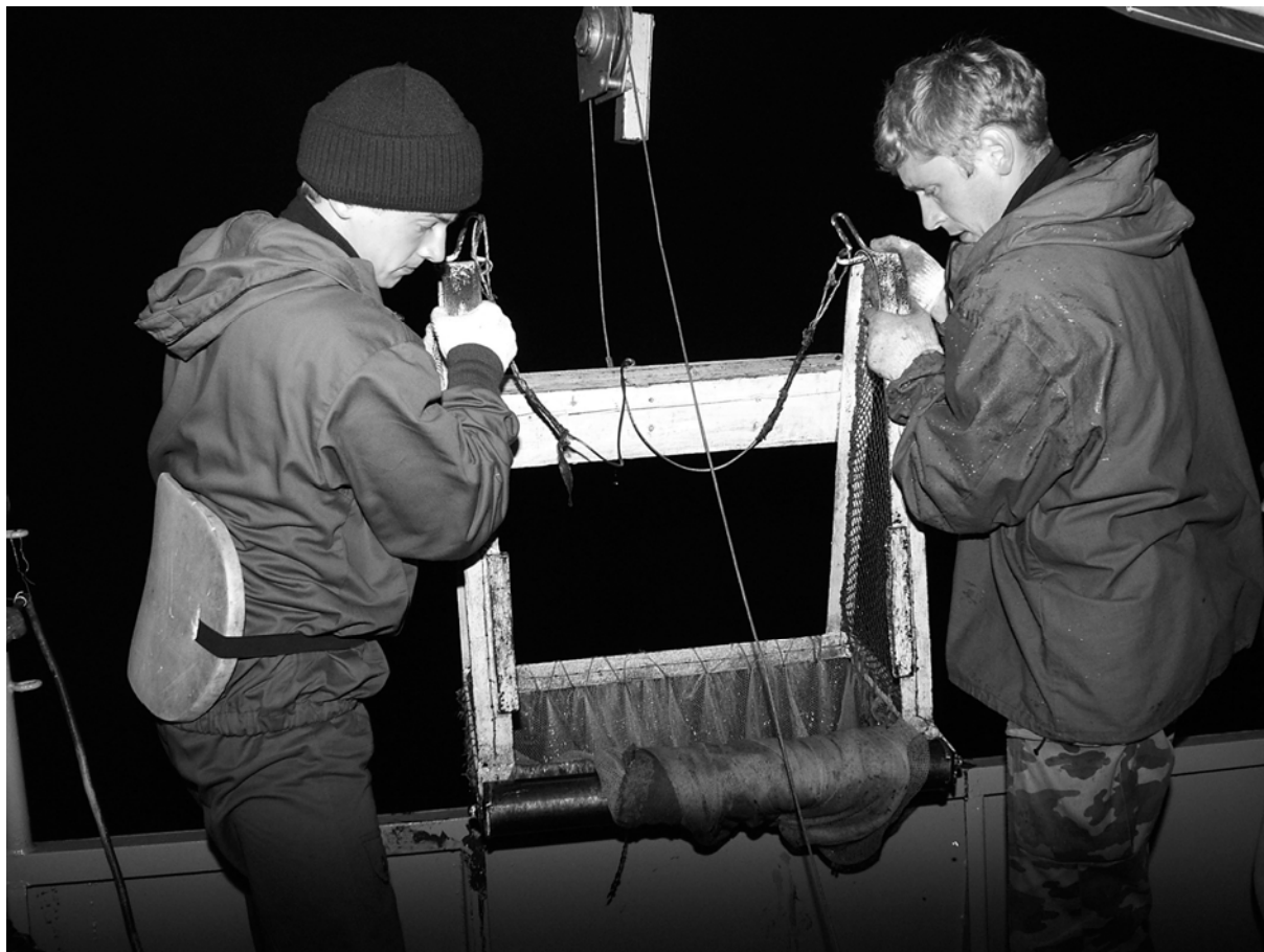
Рис. 7. Бимтрал при подъеме на палубу судна
